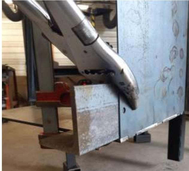
Positionner un flanc C10 perpendiculaire à C1. Pointer dans les mortaises.
