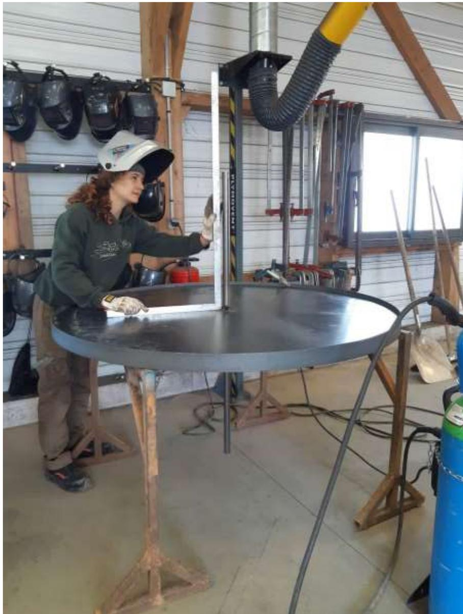
Tracer la position du support de sole inférieur sur l'axe. Positionner l'étiré central. L'équerriser aussi bien que possible. Attention, les plateaux ne sont en général pas parfaitement plats. L'axe ne peut donc pas être parfaitement d'équerre à quelque chose qui n'est pas plat. Il faut trouver le meilleur compromis.
