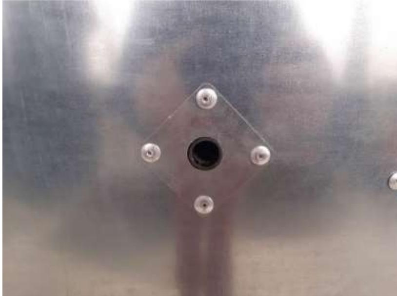
Riveter les « bouches-trou » : un pour l'entrée du tube de cuivre de l'hydratation, l'autre pour le thermomètre.
