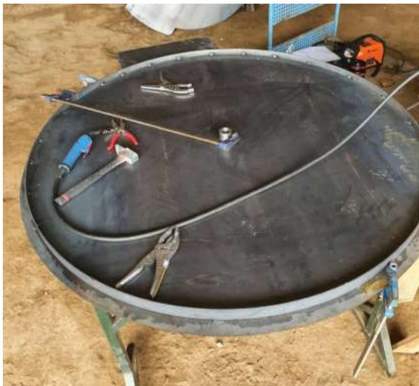
Pointer généreusement ensuite la douille au centre de B2, bien verticalement.
