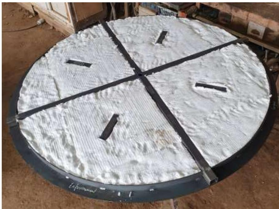
Retourner l'ensemble. Peindre l'intérieur et isoler les parties qui ne seront plus accessibles. Peindre également les faces intérieures des tôles A4 et A4' qui vont être soudées par la suite.
