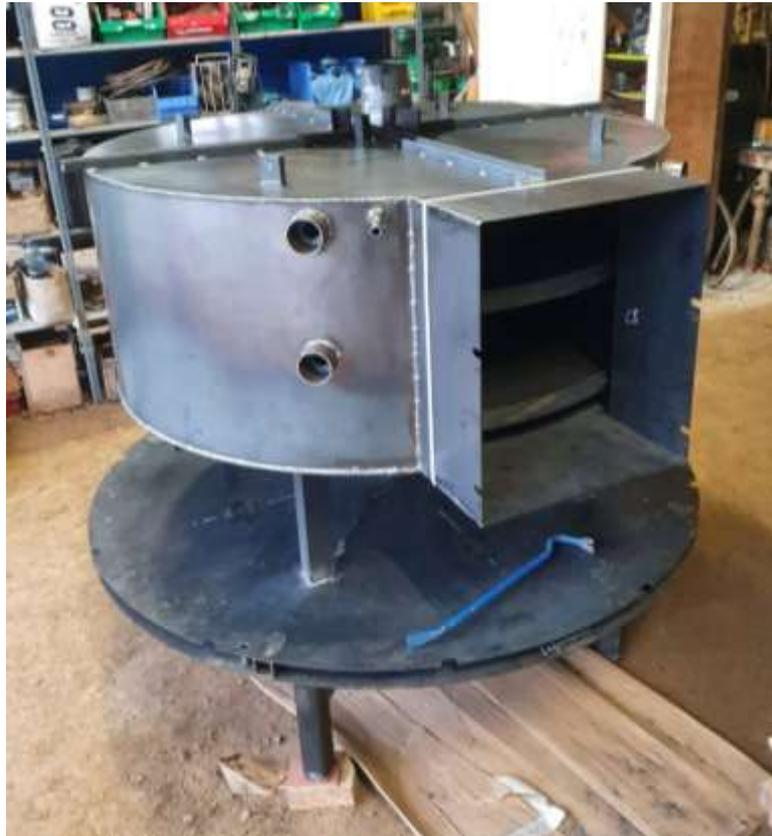
Les fers U C17 et C18 ont pour utilité de retenir le couvercle de la virole intermédiaire, ainsi que de forcer ce dernier à prendre une forme conique, pour favoriser l'échappement des fumées par le tube central.
