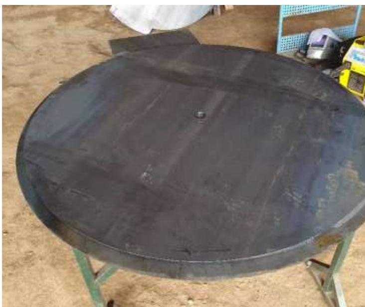
Poser la tôle B2 sur les cales. On doit avoir une cale sous le perçage central de B2.
