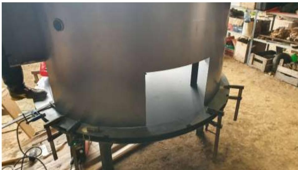
Attention au positionnement du « début » de la virole, sous l'embouchure de la chambre de cuisson. En effet, pour les versions à foyer pas en face, une tôle D7 va venir boucher cet espace. Il doit donc être de la même taille que la tôle.
