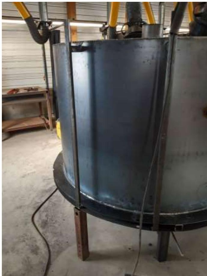
Si le four est de niveau, les T ainsi formé peuvent être positionnés au niveau à bulle : le bas est dans l'encoche, l'inclinaison radiale est gérée par F3 (nécessite que la virole intermédiaire soit bien ronde), le niveau à bulle permet de gérer l'aplomb dans le sens tangent.
