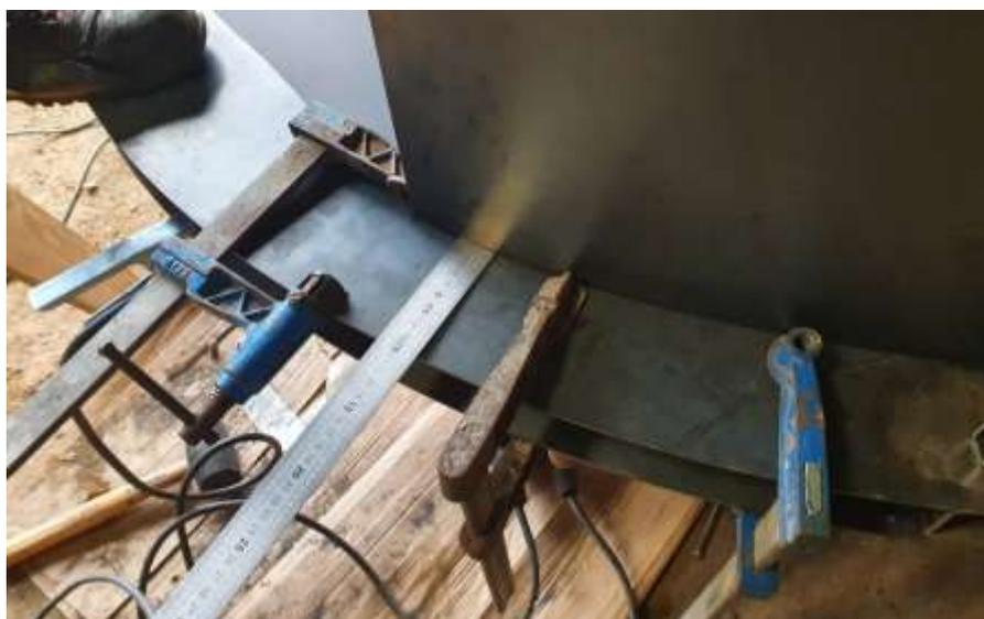
La virole doit être pointée à 100mm du bord de A3-A3'. Il est important de respecter cette cote de la manière la plus précise possible pour ne pas accumuler des défauts sur tout le pourtour et être embêté plus tard.
