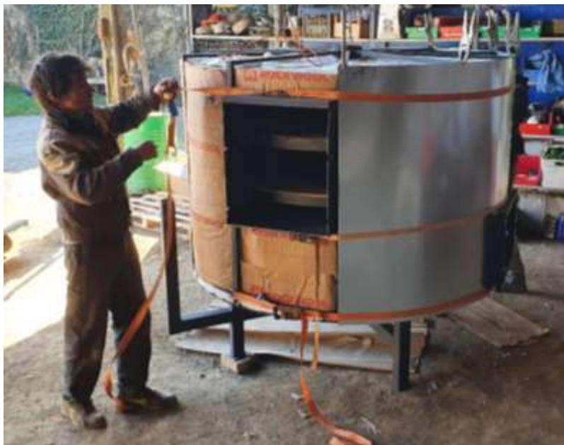
Maintenir les viroles avec des sangles à cliquet. Ne pas trop serrer, positionner, serre un peu plus, corriger le positionnement, serrer à fond. Riveter en partant de la ligne avant, puis ligne par ligne vers l'arrière. Ne pas riveter la dernière ligne, les deux viroles seront fixées en même temps.
