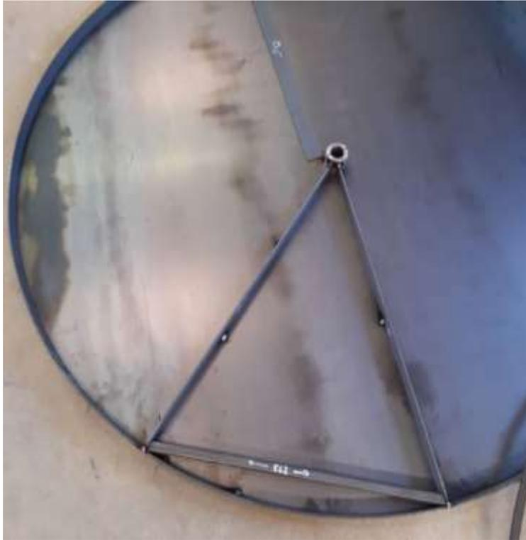
Pointer ensuite les rayons. ATTENTION AUX DEFORMATIONS ! Il faut souder juste assez pour que ça tienne et que les points ne lâchent pas sous l'effet des déformations liées à la chaleur lors des cuissons, mais pas trop pour ne pas déformer la tôle à la fabrication, au risque d'obtenir une « chips ». Un cordon de 2cm tous les 10-15cm suffit.
