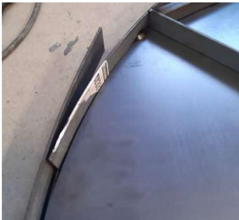
Les fers plats sont coupés trop longs car les rouleuses roulent mal les extrémités. Il faut recouper en place les deux extrémités pour avoir une belle jonction.
